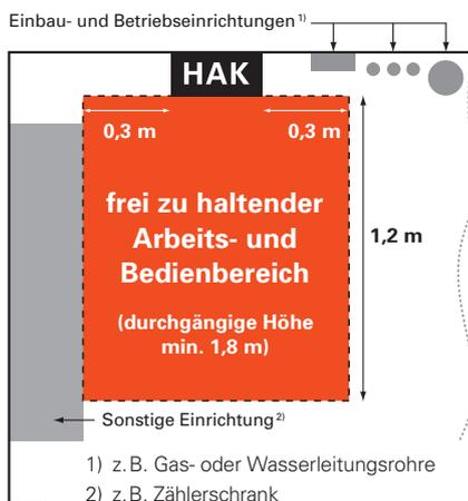
Bild 1: Arbeits- und Bedienbereich vor dem Hausanschlusskasten (HAK)
